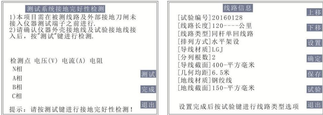
测试系统接地完好性检测界面图（9）
